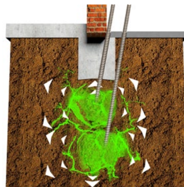
Zpevnění okolí pod základy
