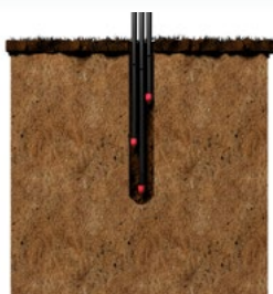
Vložení a utěsnění připraveného svazku InjektHose PE
